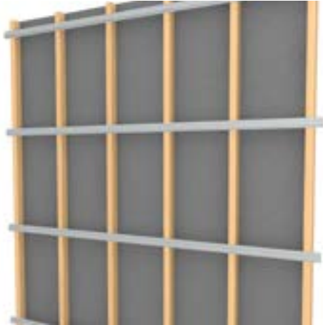
1 Querprofile an bauseitig vertikaler Konstruktion anbringen.
