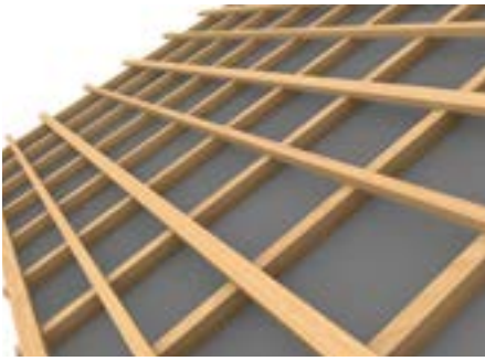
1 Dachlatten 80 x 40 und 50 x 50 werden abwechselnd im Raster aufgezogen.
