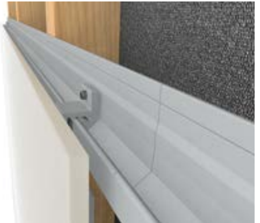
4 Modul sichern und nächstes Modul platzieren.
