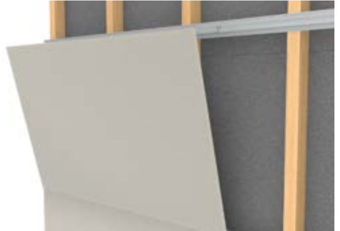
2 Modul platzieren, Schrägstellung möglich für Verkabelung.
